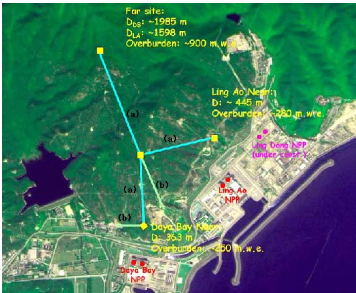
图 2-1 大亚湾反应堆的布局图和探测器可能的放置位置。(a)表示连接地下实验大厅的主隧道，(b)表示隧道的入口。
